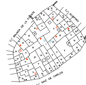
PLANTA ESTADO ACTUAL DE CUBIERTAS
