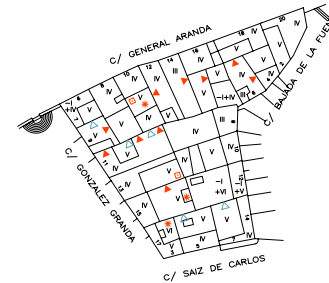
PLANTA ESTADO ACTUAL DE CUBIERTAS
